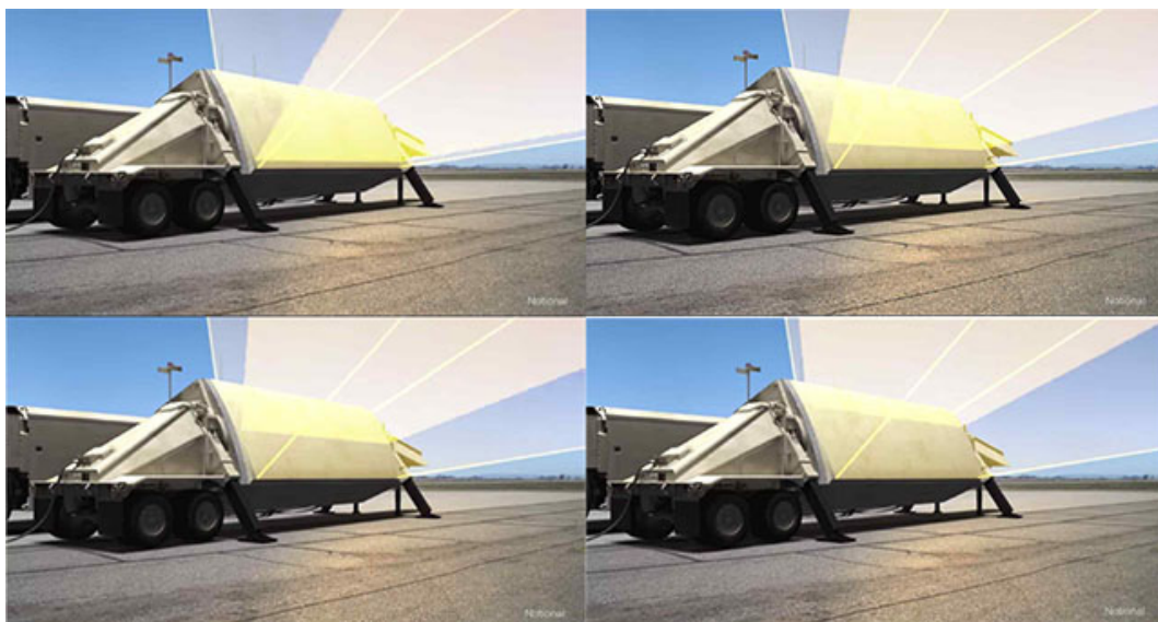
〈그림 12〉 레이시온(Raytheon)의 탄도 미사일 방어 체계 영상 중 AN/TPY-2 레이더 조사 모습 (전자파 조사는 왼쪽 위 그림부터 시계 방향으로 이루어짐)
